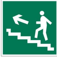
Е 16 Направление к эвакуационному выходу по лестнице вверх
