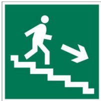
Е 13 Направление к эвакуационному выходу по лестнице вниз
