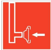
F 08 Пожарный сухотрубный стояк
