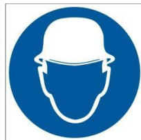
М 02 Работать в защитной каске (шлеме)
