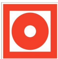
F 10 Кнопка включения систем пожарной автоматики
