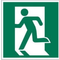
Е 01-01 Выход здесь (левосторонний)
