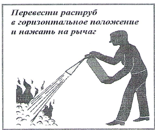
Рис.1 Приведение в действие углекислотного огнетушителя
